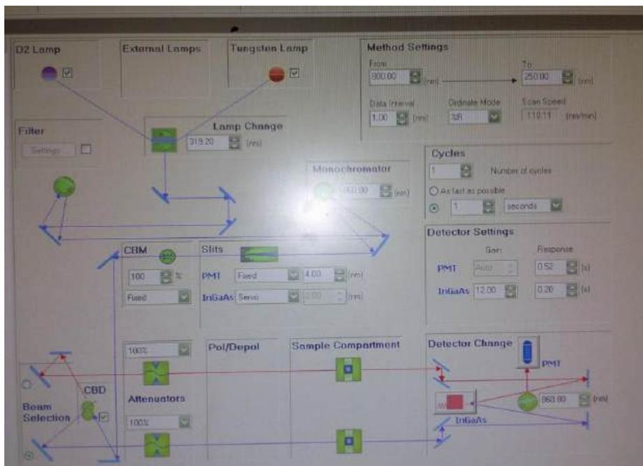
Shéma de fonctionnement du spectromètre en UV-Vis-proche IR, en réflectance.
