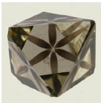
Figure 8 : Diamant polis de forme octaédrique contenant un nuage en forme de fleur à 6 pétales symétriques, 10,01 ct (Darley et al., 2009).
