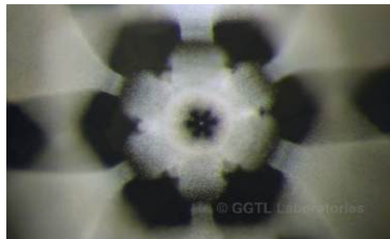
Figure 9 : Cœur d'un diamant brut de type IaAB riche en hydrogène présentant une alternance de secteurs de croissance cuboïdes et octaédriques, (GGTL Laboratories, 2014).
