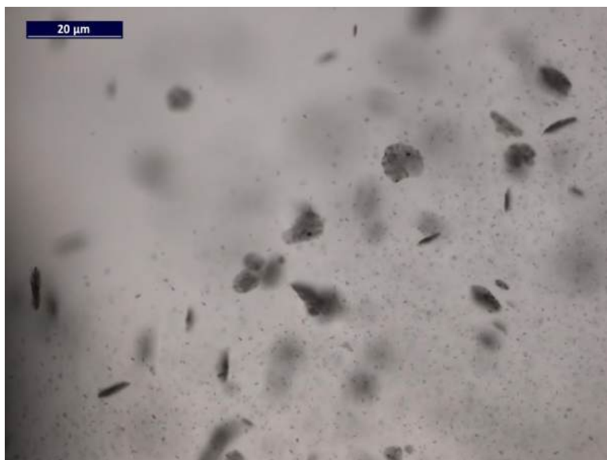
Figure 38: Inclusions discoïdes de taille variable dans le secteur cuboïde de diamant MSC67.
