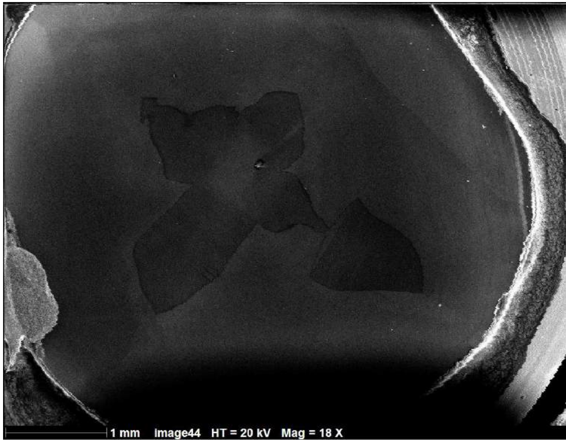
Figure 2.10 : Echantillon MSC25 observé en cathodoluminescence au MEB.
