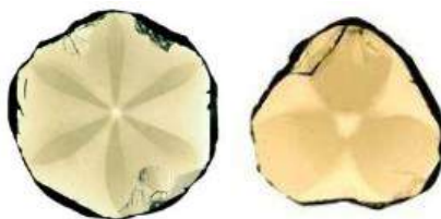
Figure 26: Lames de clivage taillées dans des diamants à croissance mixte, échantillons historiques du MNHN (Rondeau et al., 2004).
