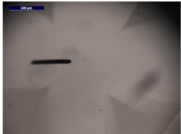
Figure 46 : Inclusion allongée dans le centre octaédrique du diamant MSC25.
