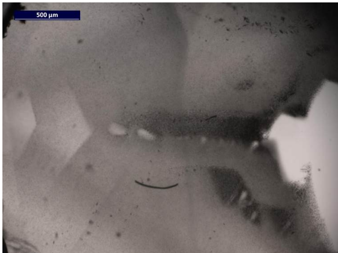
Figure 42: Le centre de l'échantillon MSC67 présente des formes géométriques soulignées par des zones plus concentrées en inclusions discoïdes.
