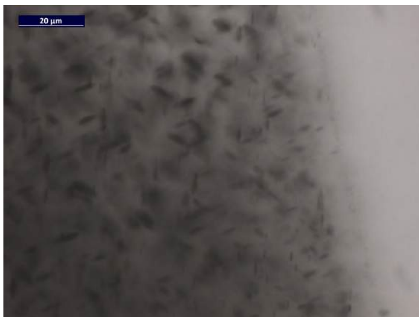
Figure 37 : Inclusions discoïdes allongées disposées dans trois directions différentes dans le secteur cuboïde de diamant MSC67.
