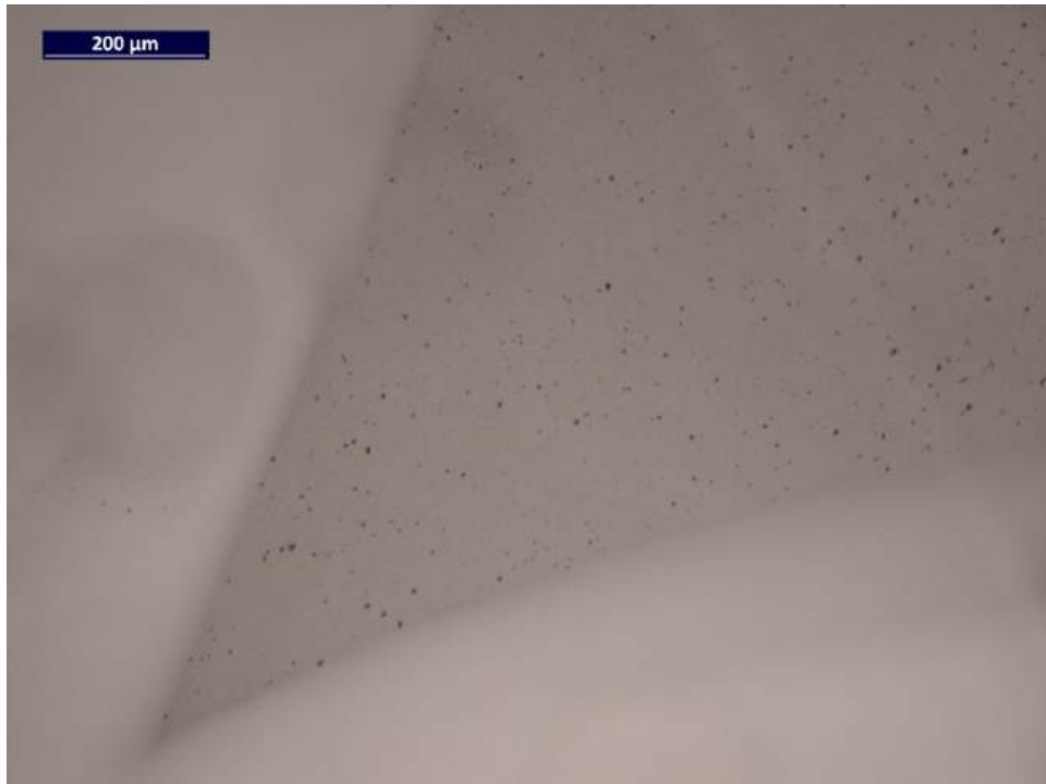
Figure 39 : Inclusions discoïdes extrêmement petites dans le secteur cuboïde de l'échantillon MSC25.
