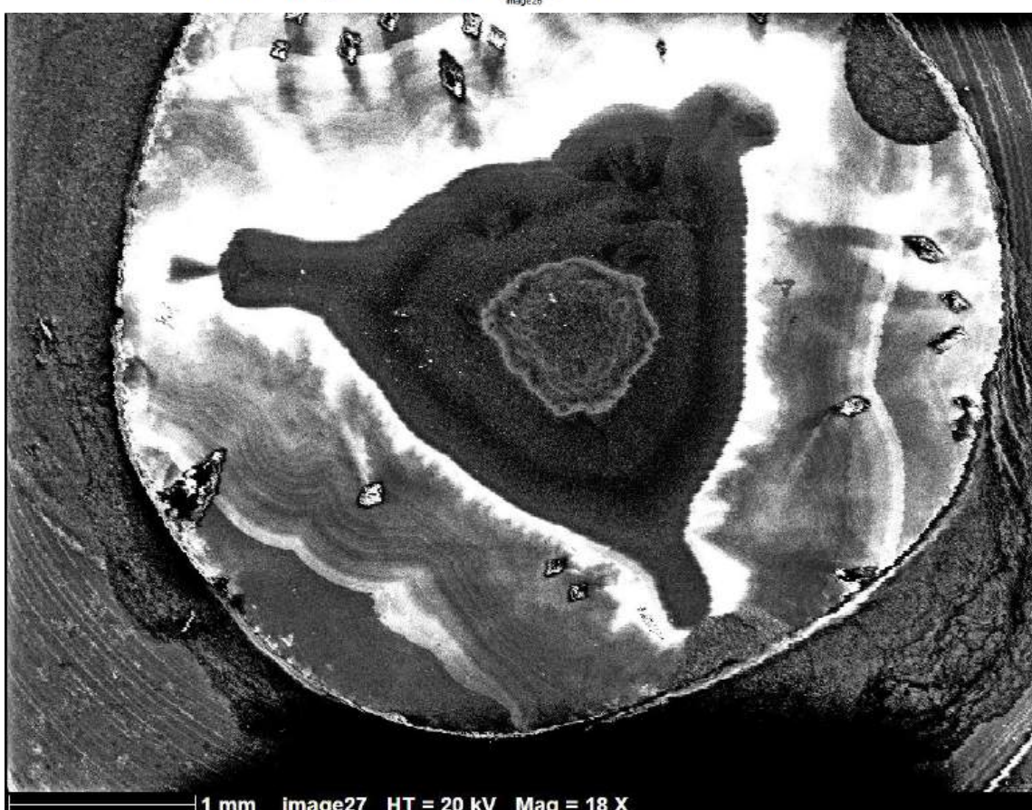
Figure 2.7 : Echantillon MSC19 observé en cathodoluminescence au MEB.
