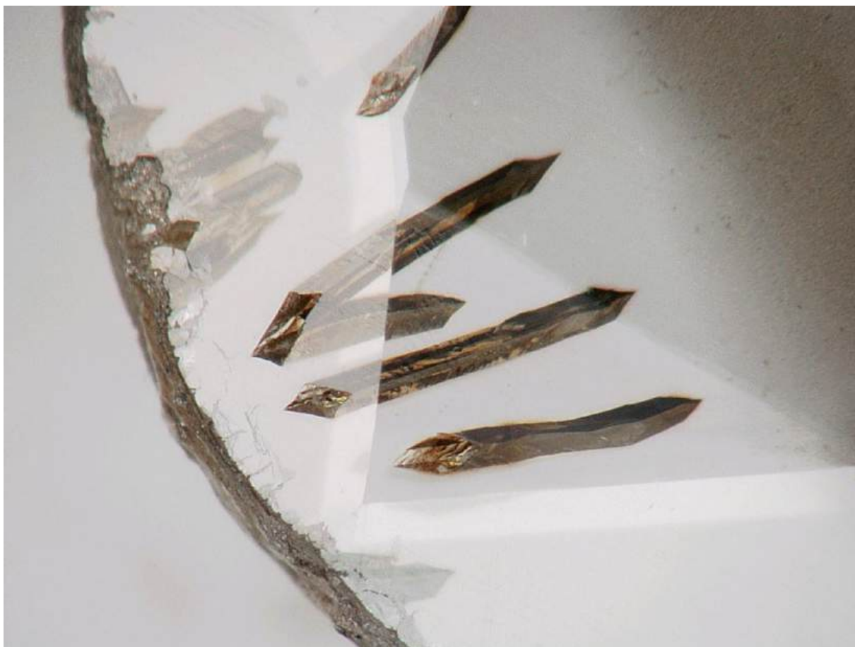
Figure 44 : Inclusions allongées et prismatiques affleurant à la surface de l'échantillon MSC19, dans un secteur octaédrique, grossissement x120.
