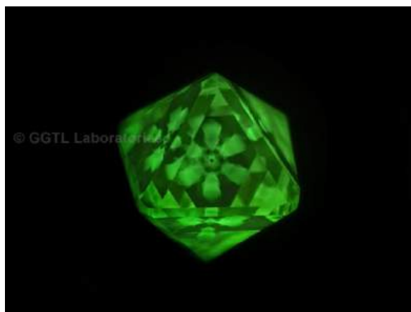
Figure 27 : Luminescence vert-jaune liée aux centres du nickel dans les secteurs cuboïdes d'un diamant astérié incolore de type IaAB, excitation à 450 nm, image U-Visio (GGTL Laboratories, 2014).
