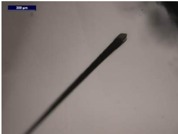
Figure 45 : Inclusion allongée et prismatique dans le secteur octaédrique du diamant MSC18.
