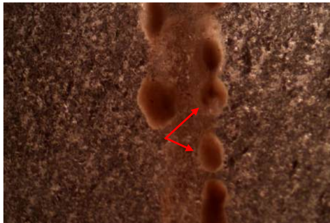
Fig. 19 : Echantillon IL12 (obsidienne acajou/larme d'apache) observé en LR montrant une texture non homogène fibreuse (largeur de champ : 10.52 mm)
