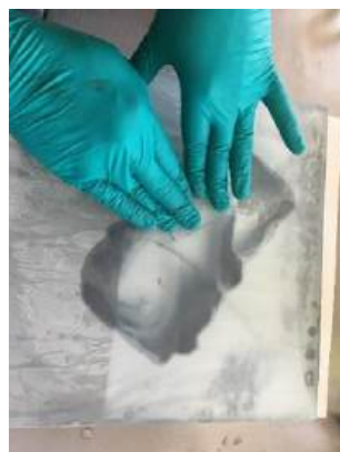
Fig. 51 : Dépolissage des lames porte-objet à l'aide d'une poudre de carbure de silicium de grains F800 (6.5 micromètres)
