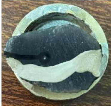
L'échantillon IL13 (agni manitite) installé sur son plot avant métallisation. L'inclusion blanche entourée par le feutre noir est particulièrement visible à l'œil nu.
