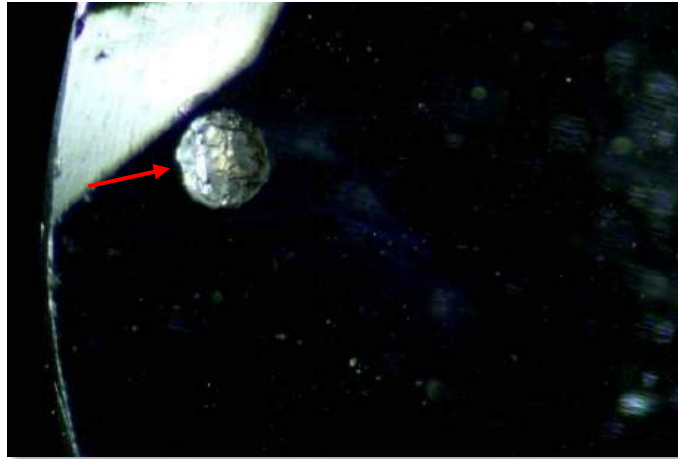
Fig. 9 : Echantillon IL04 (verre libyque) observé en LT montrant une inclusion de cristobalite (largeur de champ : 5.41 mm)
