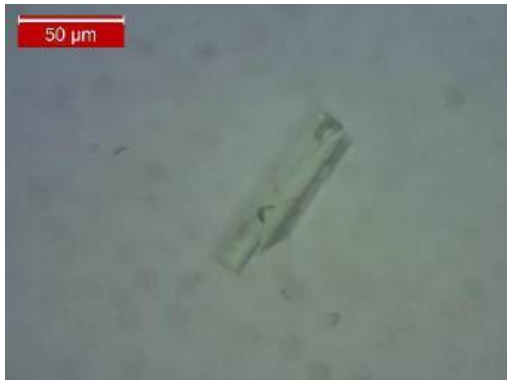
Fig. 28 : Echantillon IL10 (obsidienne argentée) photographié sous microscope optique sans filtre polarisant à gauche et avec utilisation d'un filtre polarisant à droite : il s'agit d'un cristal biréfringent, peut-être un cristal de feldspath.
