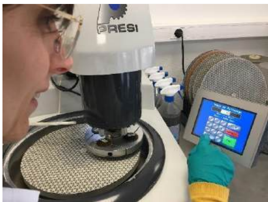
Fig. 50 : On procède au polissage de la section basale de l'échantillon à l'aide d'un tour lapidaire en utilisant différents disques diamantés (76, 54, 18 et 9 microns)
