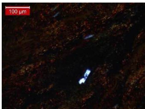
Fig. 24 : Bulles de gaz de différentes formes dans l'échantillon IL08 (verre libyque)
