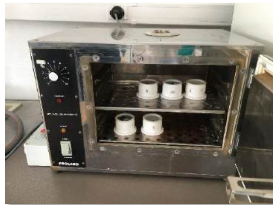
Fig. 49 : On place les échantillons dans l'étuve régulée à 60°C pour permettre le durcissement de la résine pendant environ 4 heures.
