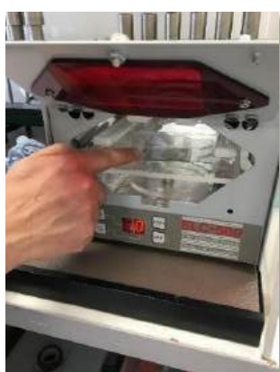
Fig. 54 : Pour terminer, la lame mince est passée dans une cabine pour collage UV. Elle est prête à être observée au microscope optique.
