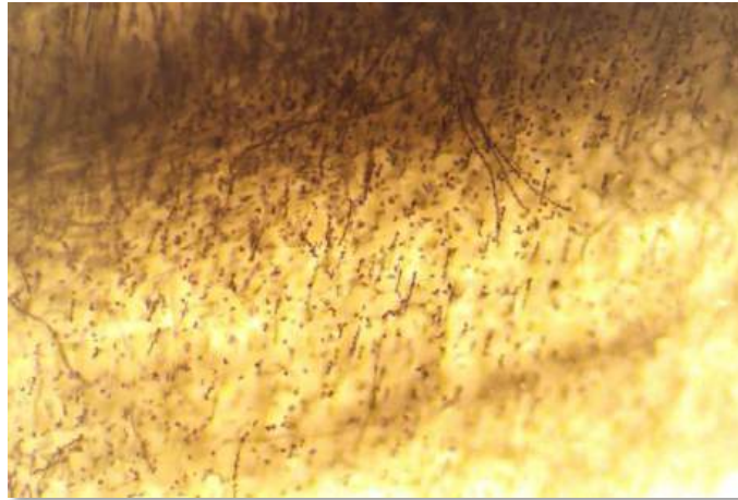
Fig. 18 : Echantillon IL11 (obsidienne acajou) observé en LT dans sa partie brune montrant un aspect en pointillés isolés en petits segments parallèle, ou en lignes courbes étendues (largeur de champ : 8.91 mm)
