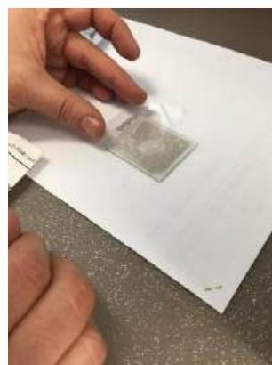
Fig. 53 : On vient coller une lamelle couvre-objet qui va protéger l'échantillon. Le collage se réalise grâce à une colle UV605.
