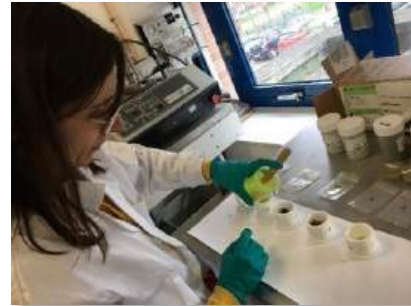
Fig. 47 : On vient couler la résine dans le moule d'un diamètre de 40 mm pour une hauteur de 35 mm dans lequel on a posé l'échantillon.
