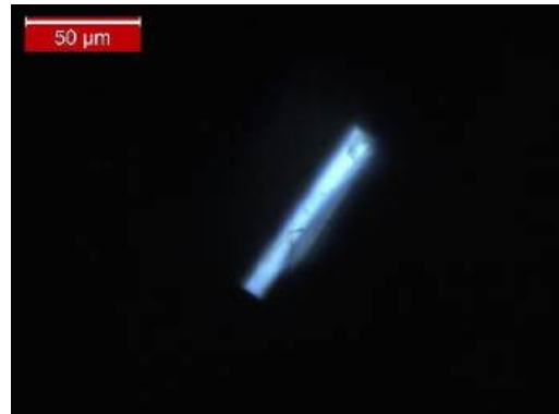
Fig. 28 : Echantillon IL10 (obsidienne argentée) photographié sous microscope optique sans filtre polarisant à gauche et avec utilisation d'un filtre polarisant à droite : il s'agit d'un cristal biréfringent, peut-être un cristal de feldspath.
