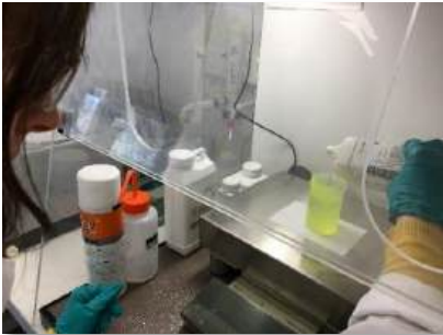
Fig. 46 : On fabrique la résine Epoxy en mélangeant la résine et le durcisseur.
