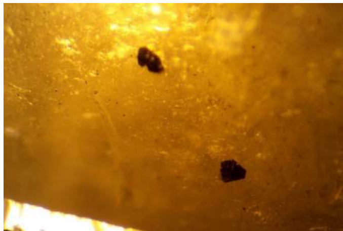
Fig. 11 : Échantillon IL02 (obsidienne « larme d'apache ») observé en LT montrant des inclusions minérales pseudo-hexagonales qui pourraient être du mica (largeur de champ : 4.88 mm)
