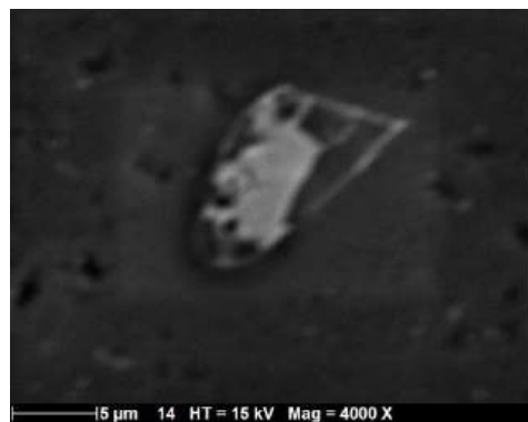
Fig. 36 : Observation au MEB de l'inclusion squelettique d'oxyde de fer dans l'échantillon IL06
