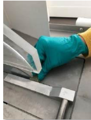
Fig. 45 : On découpe l'échantillon d'une dimension maximale de 40 mm de diamètre pour que ça rentre dans le moule.
