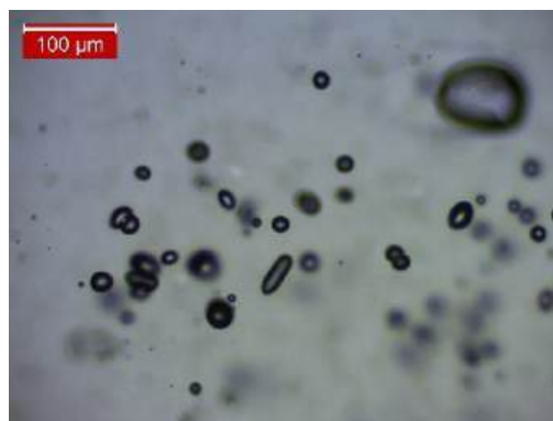
Fig. 25 : Bulle de gaz ronde dans l'échantillon IL08 (verre libyque)
