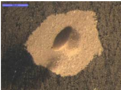
Observation en LT sous microscope de gemmologie de la zone d'inclusion blanche entourée par le feutre noir (barre d'échelle : 500 µm)
