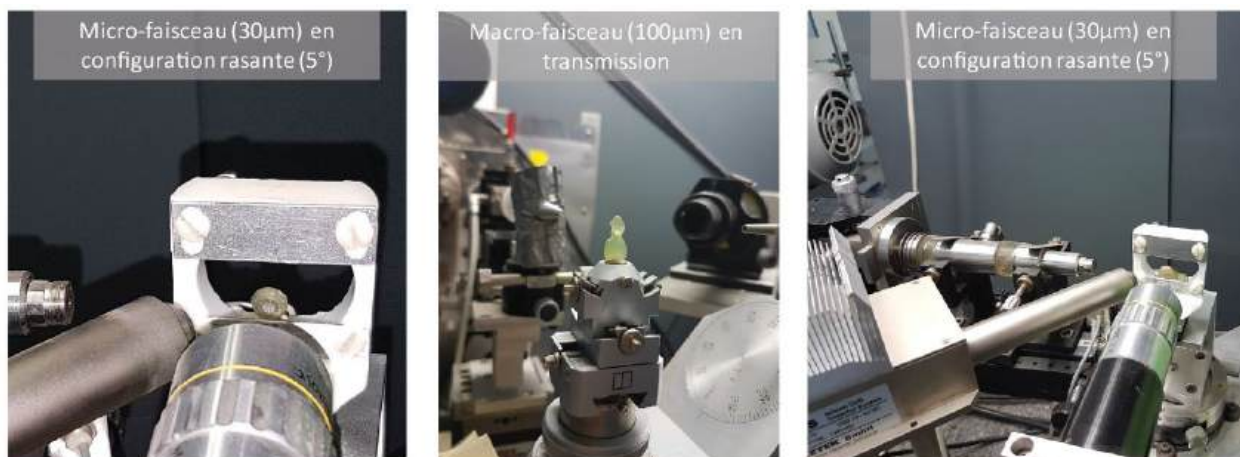
Figure 3. Vues du système de mesure en diffraction au NIMBE-LAPA et du positionnement de quelques échantillons (photos E. Foy).
