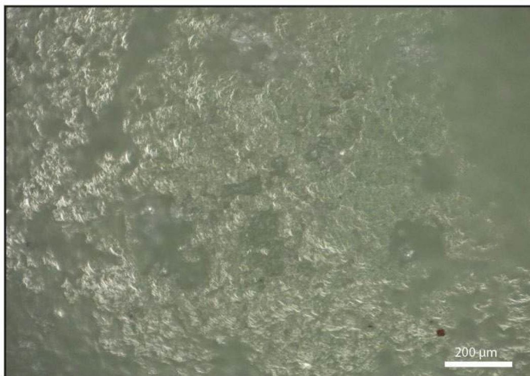
Figure 4. Microphotographie de la surface de l'échantillon GD-01-017, montrant le feuilletage du matériau observable à la loupe binoculaire.
