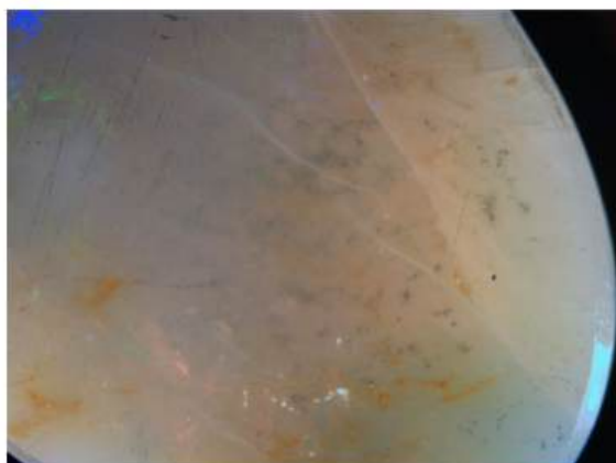
Figure 7 : Inclusions de pyrite présentes dans la masse de l'échantillon OPSP11, isolées ou en groupes, observées avec un grossissement de X25 et x150 .
