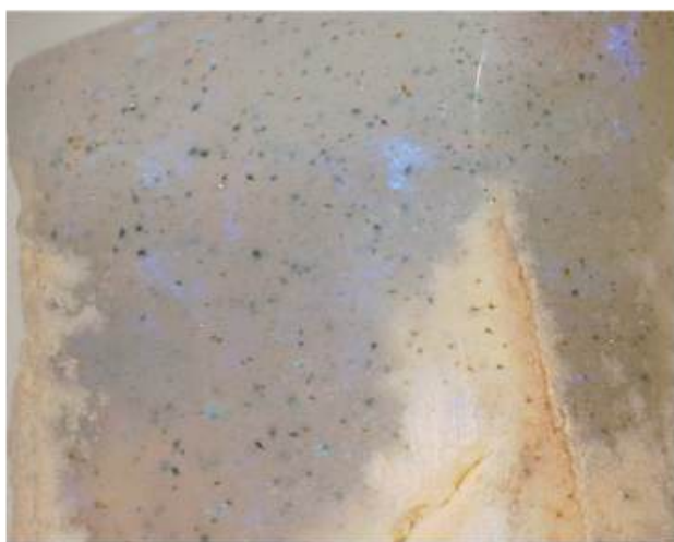
Figure 5 : Échantillon d'opale noble OPSP9 observée avec un grossissement x70, x130 et x140. Présence d'inclusions cristallines géométriques de couleur noires, oranges (oxydation) et vertes.
