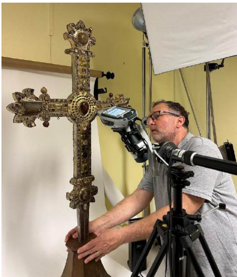
Figure 4. Analyse par fluorescence X (XRF) des gemmes et des alliages métalliques de la Croix de Castelnaud-Montmiral.
