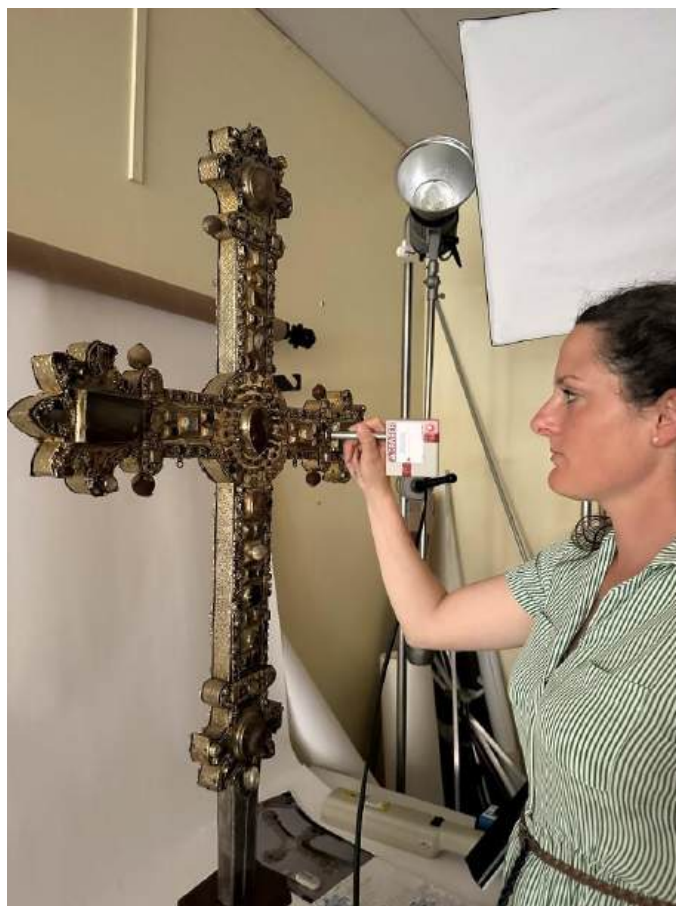
Figure 3. Analyse Raman portable Ocean Optics R 3000HR (excitation laser 785 nm) des gemmes de la Croix de Castelnau-de-Montmiral.
