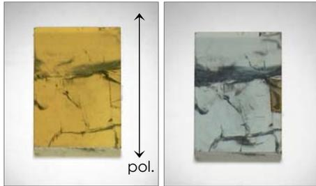
**Fig. 5:** Parallélépipède de tanzanite observé dans l'axe  $\gamma$ , La polarisation montre le rayon gamma. Avant le traitement (gauche), et après (droite) - (4.6 / 3 mm). – Tanzanite parallelepiped observed in  $\gamma$  axis, the polarisation show the gamma ray. Before treatment (left), after (right) - (4.6 / 3 mm).
