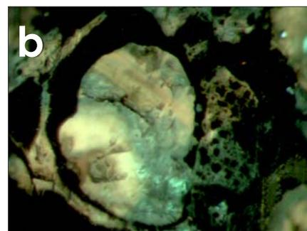
Fig. 24 - Substance étrangère fondue à la surface d'un diamant noir chauffé après la taille. Sur le cliché de luminescence "a", on peut voir que du graphite pyrolytique est piégé par la substance vitreuse. Foreign melted substance on the surface of a black diamond heated after cutting. On the luminescence picture "b" we can see that the vitreous material contains pyrolytic graphite. 50x
