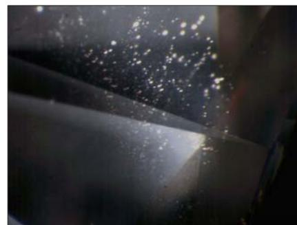
Fig. 8 – Microcavités dans un diamant incolore gemme. *Microcavities in a gem colourless diamond. 100x*
