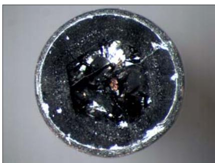
Fig. 21 - "Coated" montrant typiquement un cœur gemme et une périphérie fibreuse. "Coated" showing typically a gem core and a fibrous periphery . 40x.
