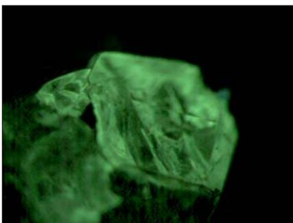
Fig. 34 - Luminescence de cavité induite par le traitement thermique. *Cavity luminescence induced by thermal treatment. 100x*
