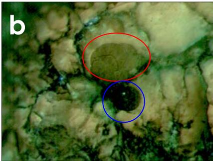
Fig. 32 - Diamant noir traité thermiquement en milieu contrôlé, après la taille. On observe des "patches" de graphitisation (en rouge) et de "DLC" plus graphite (en bleu). Le cliché "b" montre une luminescence dans la masse jaune et des luminescences de fissures vertes. *Black diamond heat treated in a controlled environment, after polishing. We observe patches of graphitization (in red) and "DLC" plus graphite (in blue). "b" shows yellow body luminescence and a green fracture luminescence. 35x*
