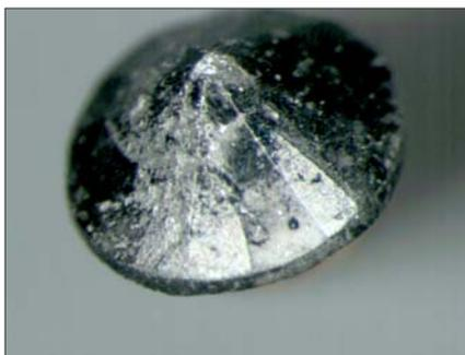
Fig. 23 - Importantes altérations à la surface de diamants noirs traités thermiquement après la taille. Important alterations on the surface of black diamonds heat treated after cutting. 20x
