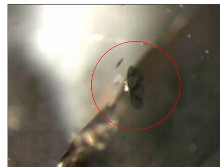
Fig. 15 – Fracture décalée par rapport à l'inclusion solide. Solid inclusion with a shifted fracture. 130x
