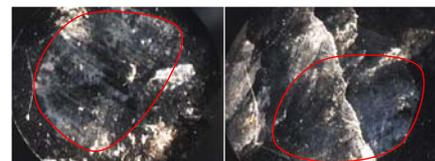
Fig. 48 - Altérations de surface (brûlures). *Surface alterations (burn).* 20x
