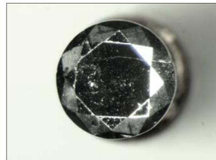
Fig. 47 - Diamant noir graphité par le processus de façonnage. Tous les bézels sont dépolis par la chaleur. *Black diamond graphitized by the cutting process. All the bezel facets are tarnished by heat.* 20x
