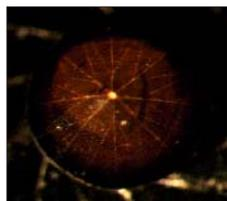
Fig. 3 - Diamant à "DLC" en surface montrant des égrisures d'arêtes. *Diamond with "DLC" on the surface showing facets abrasions. 20x*
