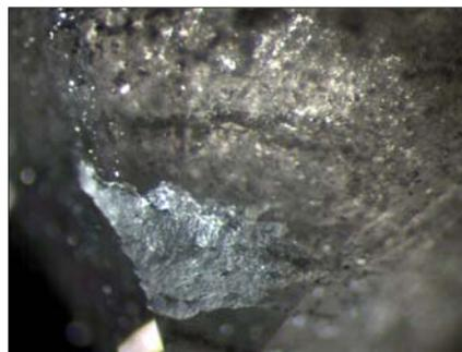
Fig. 41 - Diamant noir légèrement modifié par la chaleur de la taille. La fracture est dépolie par la formation de graphite immédiatement évaporé pendant le processus de taille. Black diamond slightly modified by the cutting heat. The frosted appearance of the fracture is due to graphite formation immediately evaporated during the cutting process. 65x
