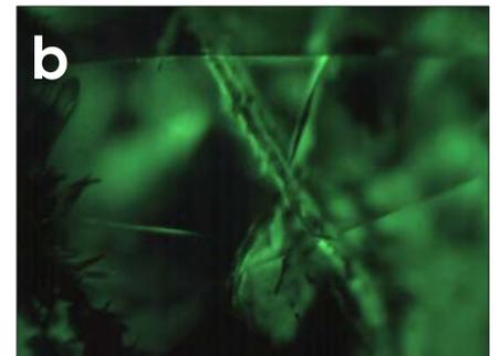
Fig. 37 - Diamant noir chauffé en milieu contrôlé. Les luminescences de fissures ne sont généralement pas observables sous lumière blanche: "a" lumière blanche, "b" luminescence. *Black diamond heated in controlled environment. Fracture luminescence is usually not observable under white light: "a" white light, "b" luminescence. 50x*
