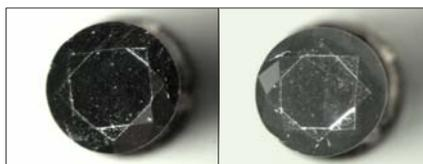
Fig. 40 - Diamants noirs graphitisés par la chaleur de la taille, dans les mêmes conditions. La modification est variable d'un individu à l'autre. Black diamonds graphitized by the polishing heat in the same conditions. The modification is variable. 20x
