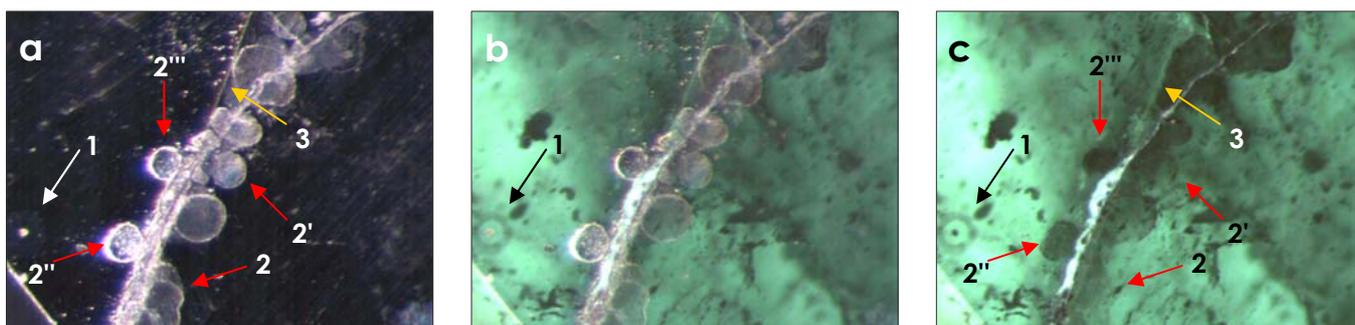
Fig. 60 - Diamant noir traité par faisceau ionique de C<sup>+</sup>. Microphotographies de la même zone; "a" en lumière réfléchie, "c" en luminescence et "b" mixte.
