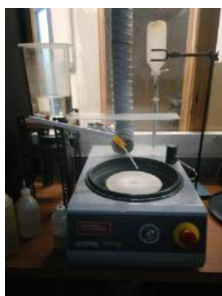
Fig. 8 : polisseuse de l'atelier de litho-préparation de l'université de Nantes
