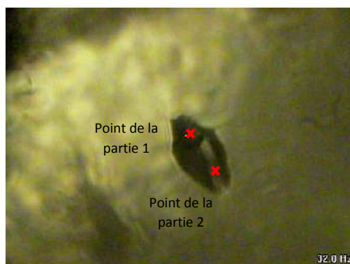
Fig. 81 : Capture d'écran de l'image observée au microscope du Raman dispersif avec un pointage des zones analysées. *
