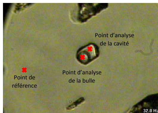
Fig. 68 : Capture d'écran de l'image observée au microscope du Raman dispersif avec les différentes zones d'analyses. ✕
