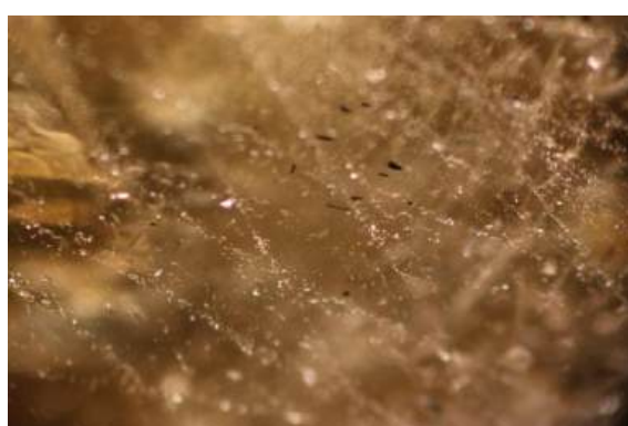
Fig. 33 : Inclusions cristallines noires type microlites ? Sous grossissement x40 en lumière réfléchie
