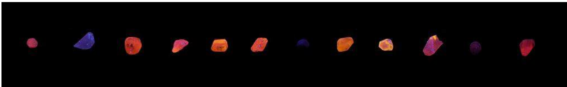
Figure n°18 : luminescence des échantillons sélectionnés (de gauche à droite, PL-01 à PL-12) aux UV longs (365 nm). L'image a été obtenue avec les paramètres suivants : ISO 400, F/8, 5 secondes de temps de pause.
