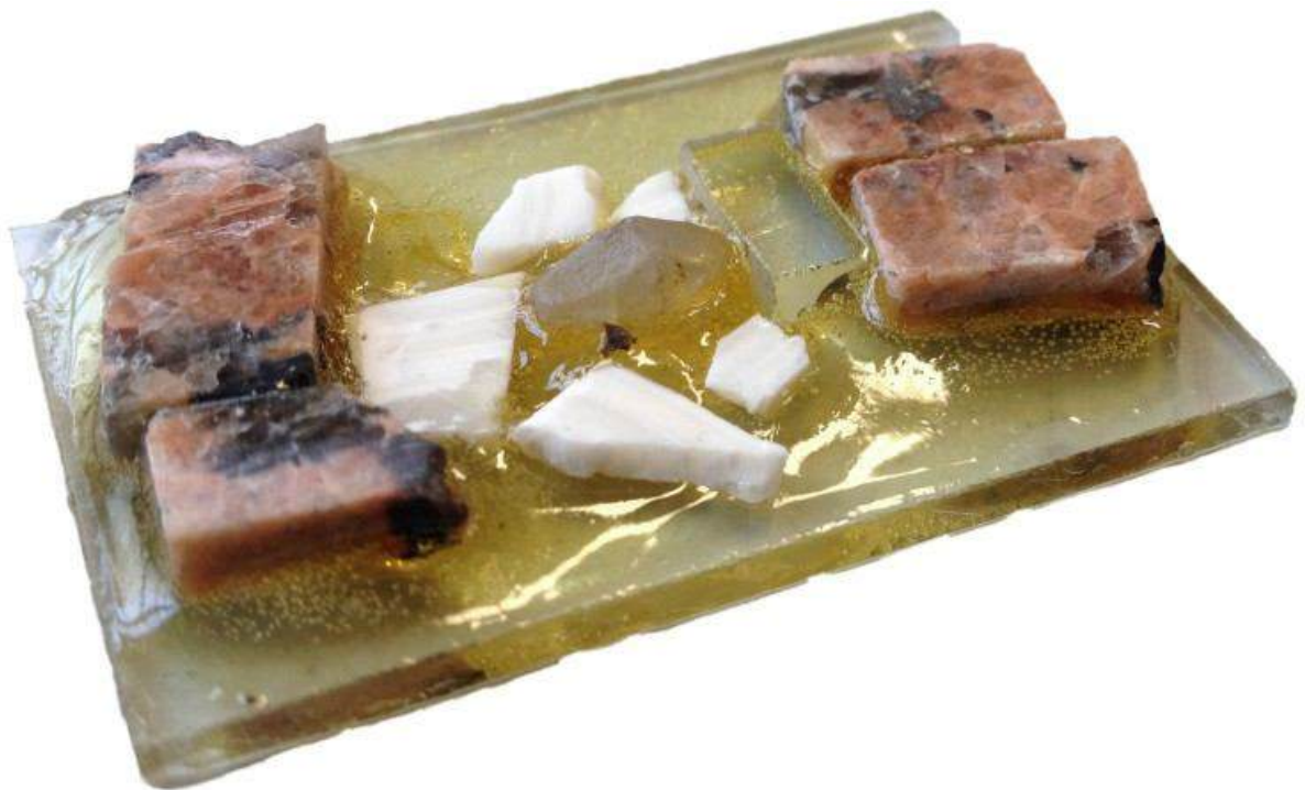
Figure n° 12: préparation du polissage des échantillons. Ici le cristal PL-01 a été positionné avec l'axe C parallèle à la surface de la lame de verre porteuse grâce à une résine et diverses cales. Les grosses cales en granite rose assurent la stabilité durant les opérations sur la table de polissage.
