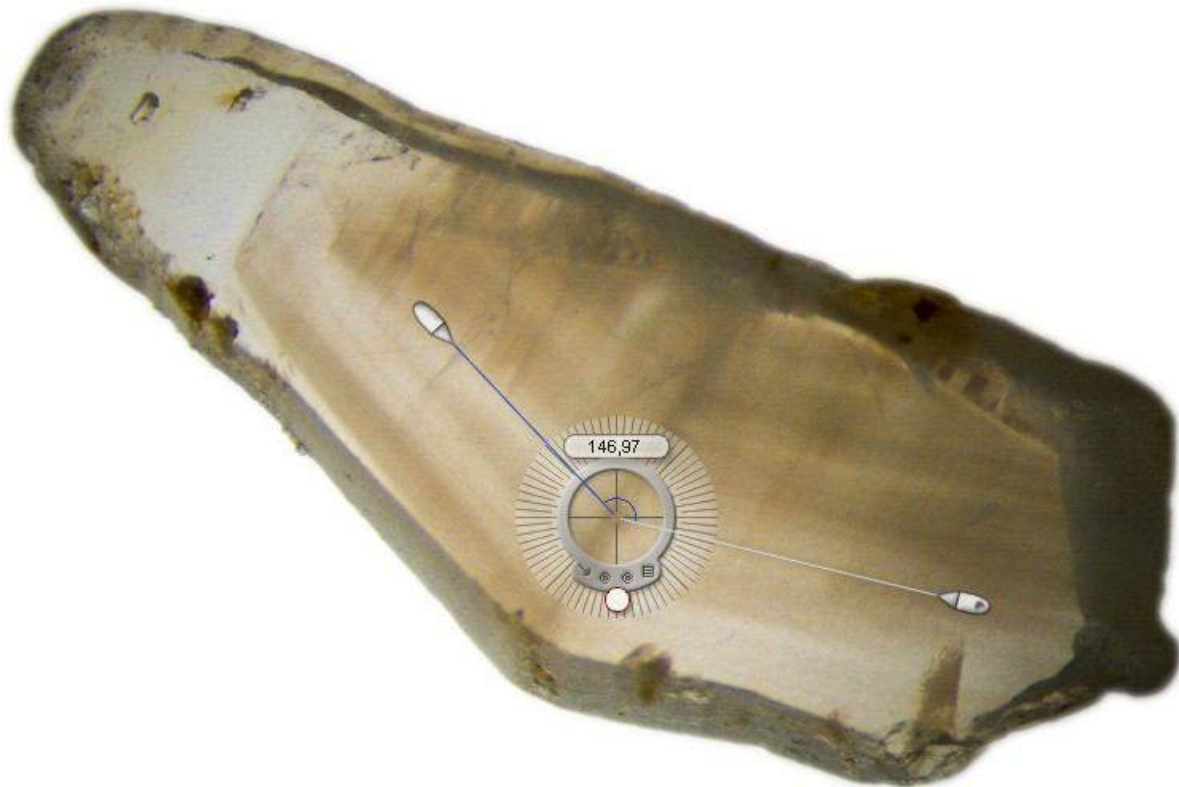
Figure n°16: Image à la binoculaire de l'échantillon PL-04, montrant les zonations, leur orientation, ainsi qu'un effet de couleur qui pourrait être l'effet diesel.
