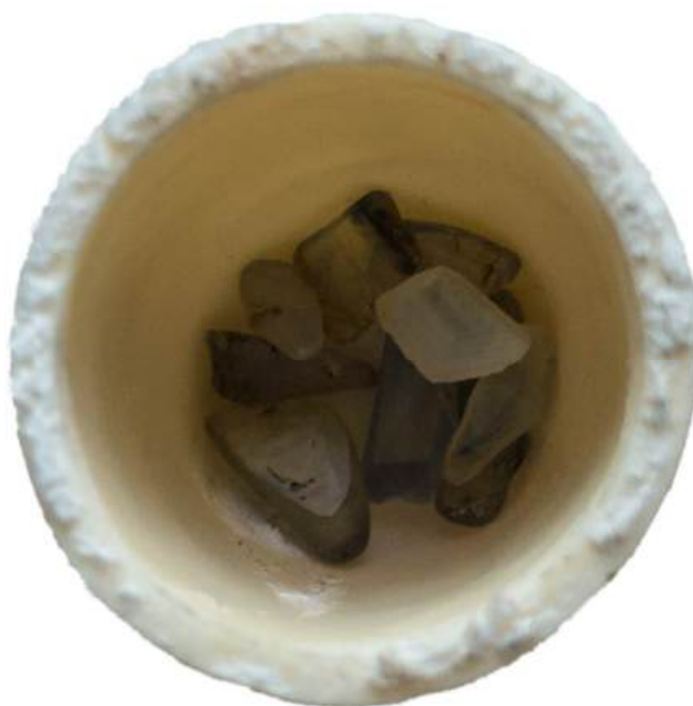
Figure n° 48: Les échantillons de geudas pêle-mêle dans leur creuset avant chauffage. Notez l'absence d'utilisation d'une masse thermique pour la protection des pierres. Le creuset est ensuite recouvert d'un couvercle qui est scellé à l'aide d'un ciment préparé juste avant la chauffe.
