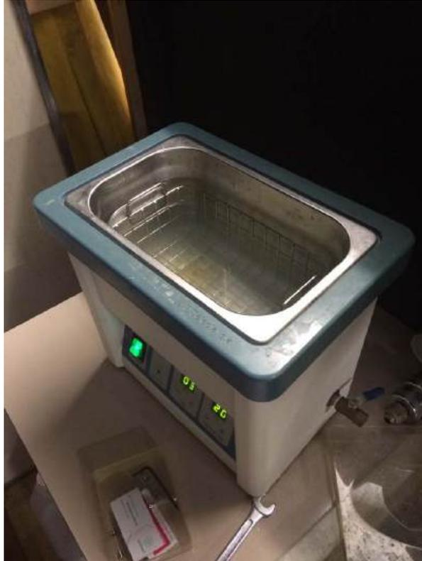
Figure 72: Bac à ultrasons en cours de fonctionnement avec un échantillon en nettoyage.
