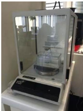
Figure 35: Balance hydrostatique utilisée pour la mesure de la densité.
