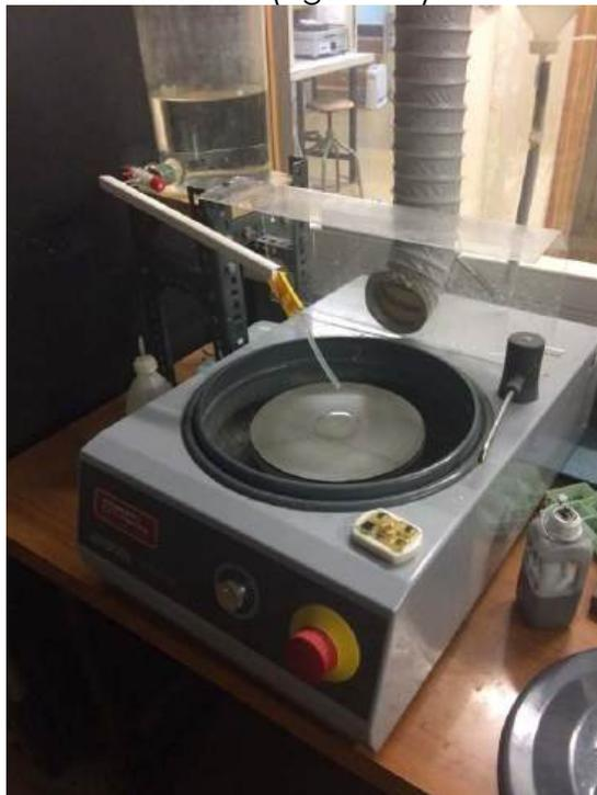
Figure 71: tour pour polir à 3 micron mètres et 6 micron mètres.
