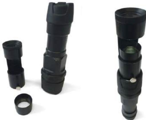
Figure 34: polariscope utilisé pour l'observation des échantillons étudiés.
