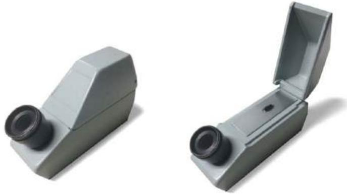
Figure 33: réfractomètre utilisé pour les mesures d'indice de réfraction des échantillons étudiés.
