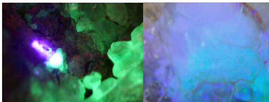
Figure 21a (gauche) : UH12, détail de la partie jaune-verte excitée par un laser à 405 nm (violet donc), à gauche. Il en va de même pour HU13. Largeur de l'image : 5 cm. Figure 21b (droite) : émission bleue dans la partie blanche. Largeur de l'image : 3 cm.
