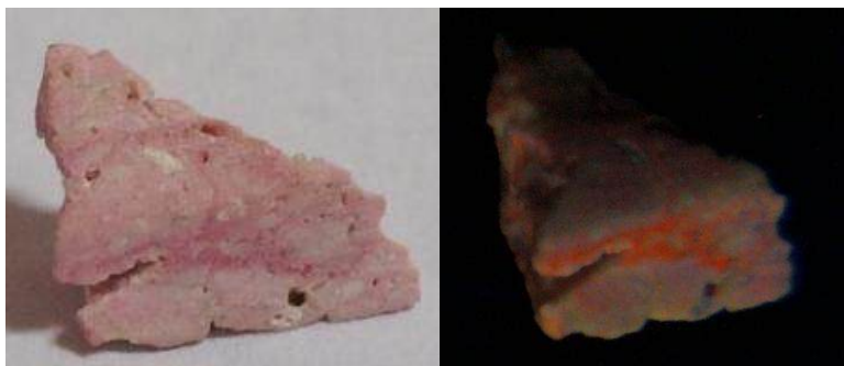
Figure 20a (gauche) et 20b (droite) : UH10 en lumière blanche et aux UVL, détail. Répartition de la luminescence en fonction de la répartition de la couleur. Largeur de l'image : 1,2 cm.
