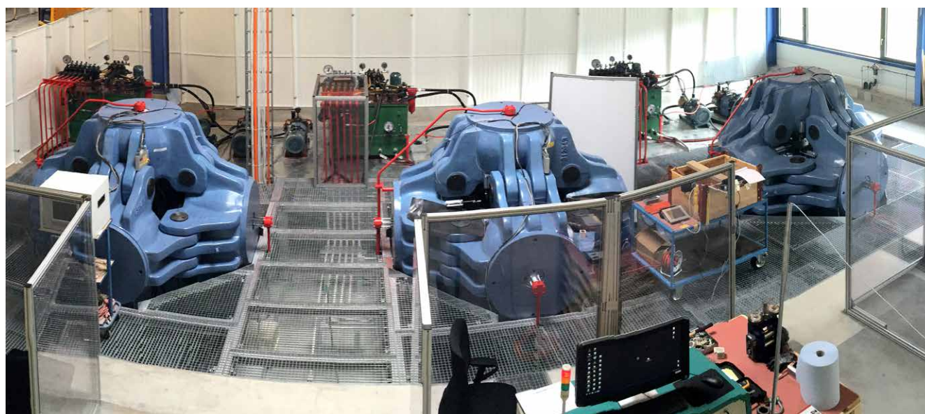
Abb. 4 Drei Hochdruck-Hochtemperatur Pressen – sogenannte kubische Pressen – wie sie zur HPHT Diamantsynthese und auch zur HPHT Behandlung verwendet werden. Foto T. Hainschwang.
