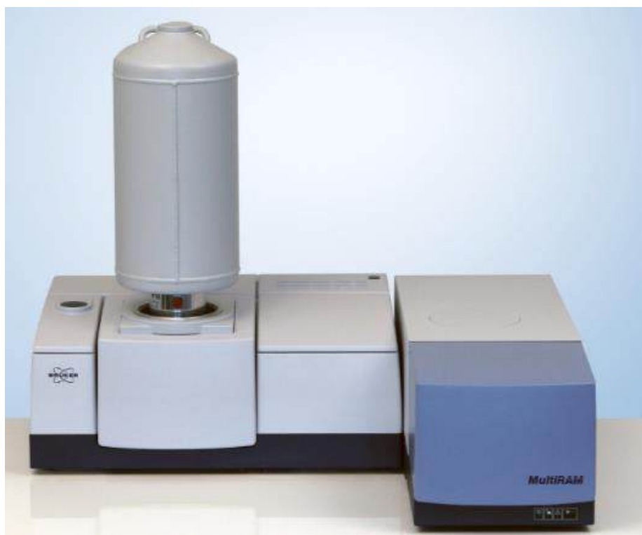
Figure 11. Raman à transformée de Fourier utilisé pour les analyses d'opales.
