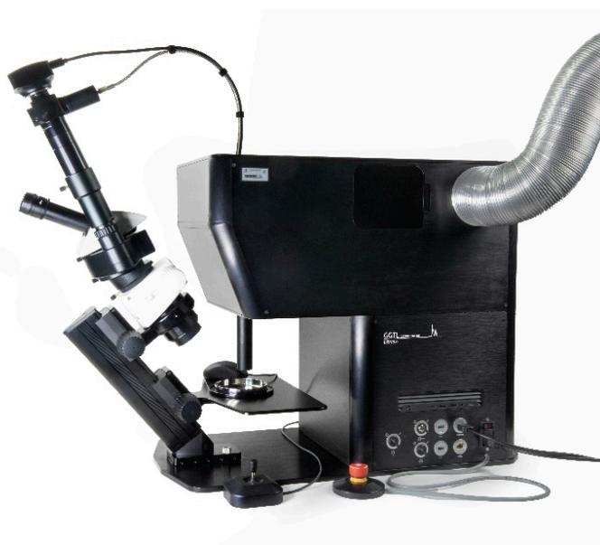
acquisition avec un très bon rapport signal sur bruit. Le DFI<sup>©</sup> V3 peut être équipé d'un ou deux spectromètres, l'option à un spectromètre offre une résolution de 1.3 nm, celle à deux spectromètres une résolution de 0.3 nm pour l'un (UV-Vis) et 0.7 nm pour l'autre (Vis-NIR). Pour un usage professionnel de tri de lots de diamants "mêlé", ou pour les pierres individuelles, la version à un spectromètre suffit.
