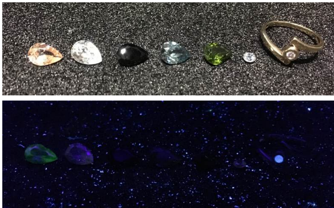
Fig. 2. Photos des échantillons facettés exposés à la lumière de la pièce (partie supérieure), et dans le noir sous UV-longs (partie inférieure). Seul l'échantillon MD01 réagit, avec une faible luminescence verdâtre (la luminescence du diamant est beaucoup plus intense en comparaison). L'apparence légèrement blanchâtre de l'échantillon MD02 donne l'impression que la pierre réagit aussi, mais il n'en est rien. Il ne s'agit que d'un artéfact lié à l'appareil photo.
