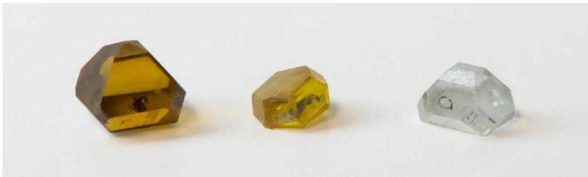
Figure 94. Diamants synthétiques HPHT jaunes et incolore as-grown. Le diamant à gauche montre un germe (zone noire).
