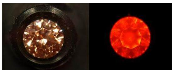
Figure 109. Diamant synthétique CVD rose (gauche). Ce même diamant observé au DiamondView, il présente une luminescence rouge orangée. Photo E. Fritsch.
