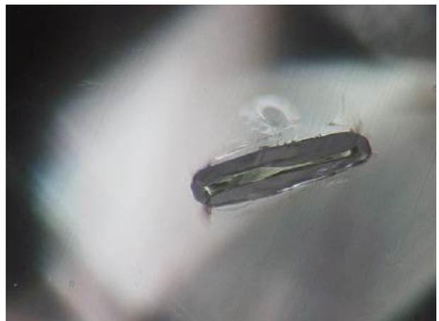
Figure 41. Inclusion de pyroxène dans un diamant, grossissement x150. Le pyroxène communément présent dans les roches du manteau est le diopside  $CaMg(SiO_3)_2$  et se retrouve en inclusion dans le diamant. Photo © Laboratoire Français de Gemmologie.
