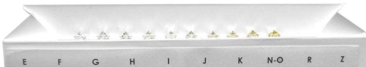
Figure 64. Série d'étalons pour la gradation de la couleur des diamants de la série Cape dans leur support permettant l'observation par le pavillon. Photo F.Notari.
