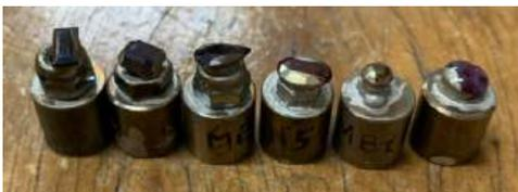
*Figure 2 : Échantillons montés sur plots à l'aide de laque d'argent puis métallisés.*
