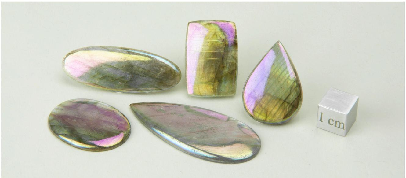
**Figure 2 :** Labradorites recouverte d'une couche mince métallique (Réf. SGDF-16569 à -16573). Photo F. Blumentritt.
