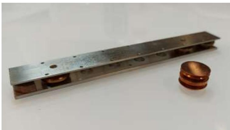
*Figure 27 : Supports d'échantillons pour des analyses XPS avec la barre ou le plot sur lesquels sont fixés les poudres (pastilles ou non) à l'aide de scotch carbone.*
