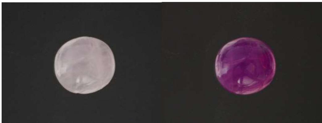
*Figure 1 : Chouchou avant (gauche) et après (droite) illumination sous ultraviolet (254 nm) pendant quelques secondes.*
