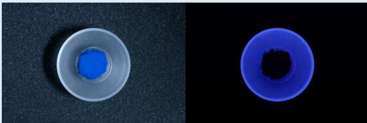
**Figure B** : Sodalite bleue synthétique (M091) sous lumière naturelle à gauche et sous UVL à droite. Sur ces photos, rien ne semble indiquer une quelconque luminescence de l'échantillon.
