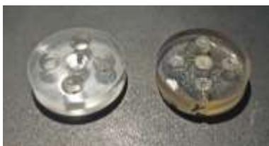
Figure 20 : Préparation des échantillons pulvérulents pour l'analyse EDS avec (à droite) un cylindre vide et (à gauche) un cylindre rempli, poli et métallisé pour l'analyse EDS.
