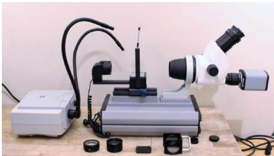
Figure 12 : ensemble source lumière froide, base du microscope horizontale, optique trinoculaire et caméra numérique.
