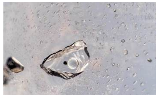
Figure 6 : Une inclusion mutliphase, contenant du liquide, une bulle de gaz \text{CO}_2 et un petit cristal. Photomicrographie par Victoria Raynaud.
