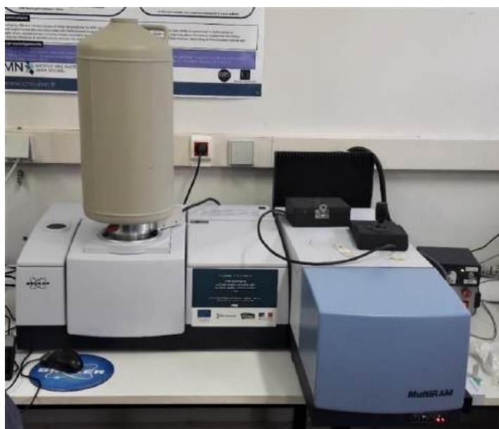
Figure 17 : Spectromètre Raman à transformée de Fourier (FT-Raman) de marque Bruker modèle Multi RAM.
