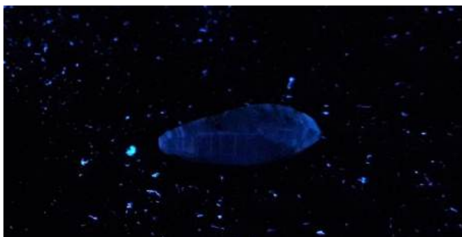
Figure 28 : Luminescence de OB.2 aux UVC après traitement.
