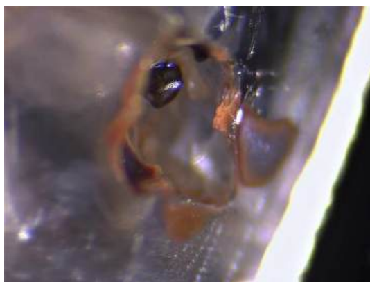
Figure 46 : Ces mêmes cavités altérées par le traitement qui présentent des traces de couleur rouille.
